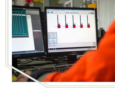
Die im Lager von Oxford eingesetzten FTS sind lasergeführt. Ein Laserscanner oben am FTS misst die Winkel und die Abstände zu an Wänden und Regalen montierten Reflektoren. Das Transportsystem trianguliert dann seine Position innerhalb des Lagers und bewegt sich entsprechend an die programmierte Position. Die Genauigkeit dabei beträgt +/- 5,0 mm.
